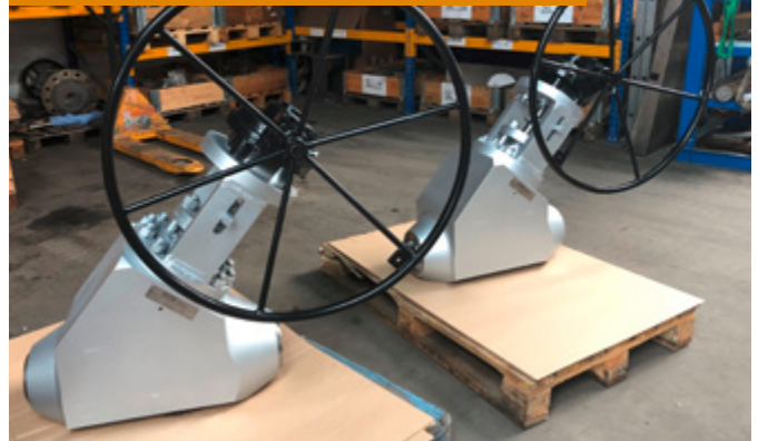
Schrägsitzventile NPS 6 Class 2500
