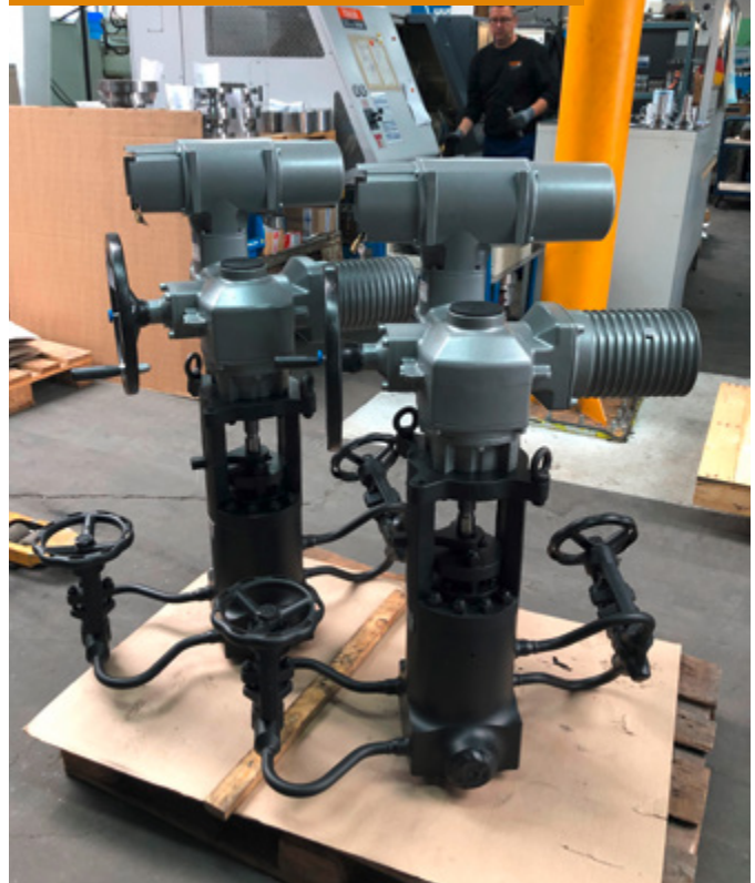
Schieber mit Bypass NPS 3 Class 2500
