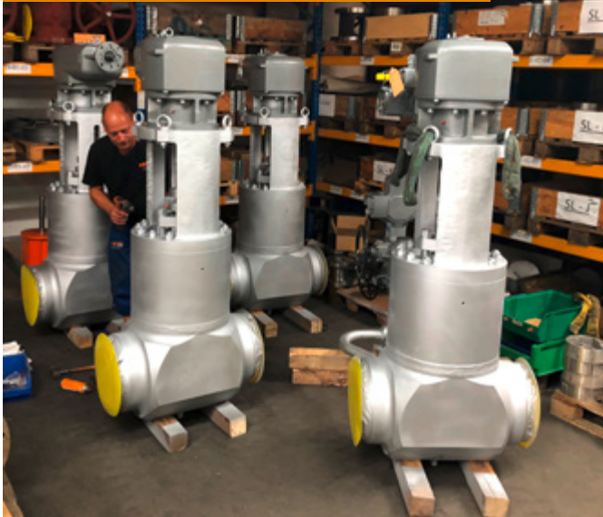
Hochdruckschieber NPS 12 Class 2500
